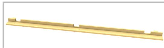
Mit dieser Montageschablone wird das Zwischenmaß der Pfosten für 180 x 180 cm Zaunfelder sowie die Position der verdeckt montierbaren Elementhalter Art. 2166 bestimmt.
